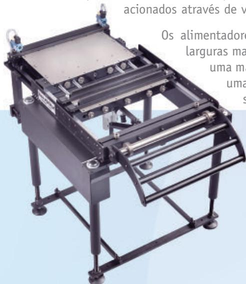
Os alimentadores das séries SX - ZX são muito adequados para a alimentação de chapas com larguras maiores e espessuras finas. As séries SX - ZX e V - K utilizam dois cilindros para obter uma máxima força de tração. Os alimentadores da série Pesada e Extra Pesada desenvolvem uma força muito elevada em uma estrutura compacta. A série Extra Pesada caracteriza-se pela existência de 4 cilindros de tração.
